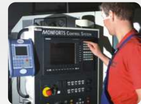
IPC Vario 5.7 als Maschinendatenerfassungs-Terminal. Industrial-PC Vario 5.7 as device for machine data collection.
