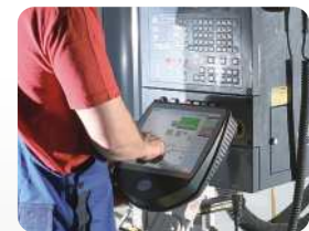
IPC Vario 12 als Maschinendatenerfassungs-Terminal. Industrial-PC Vario 12 as device for machine data collection.
